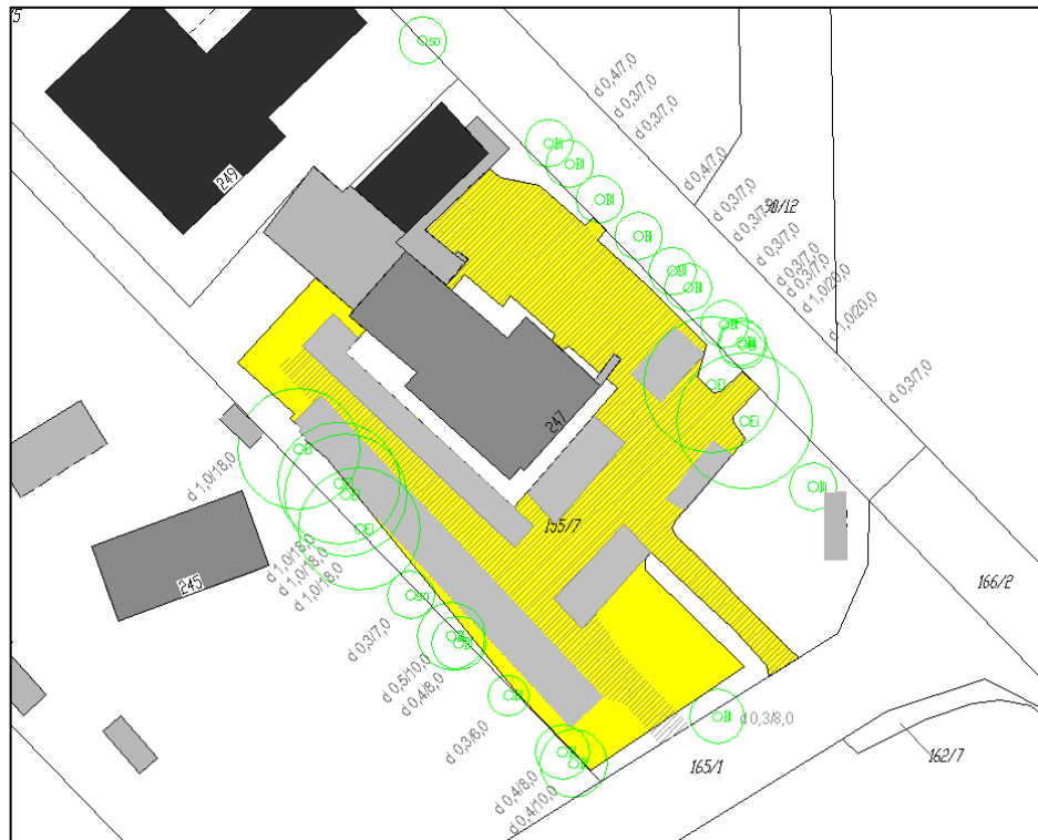
Abb. 4: Darstellung der Versiegelungssituation [aktueller Bestand: gelb / genehmigter Bestand von 1991: grau gestrichelt (Zufahrt), grau (PKW-Stellplätze) im Bereich der eingemessenen Kronentraufen].
